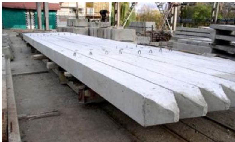
Рисунок 1 - Сборные забивные сваи длиной 17 метров изготовленные по новой композитной нано-технологии на заводе ЖБИ-17 („Спецстройбетон“) Главмоспромстройматериалы, 1985 год. Автор уникальной нанотехнологии инженер А.Б.Тринкер
