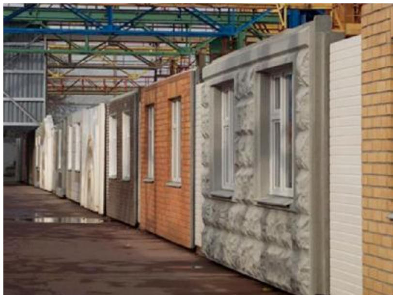
Рисунок 2 - Наружные стеновые панели, изготовленные по новой композитной нанотехнологии на Краснопресненском заводе ЖБК ДСК № 1 Главмосстроя, 1986 год. Автор уникальной нано-технологии инженер А.Б.Тринкер
